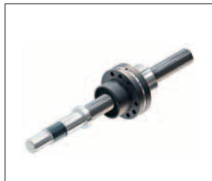
En los sistemas con tuercas precargadas, la deformación por las diferentes cargas es mucho menor que en los sistemas con tuercas no precargados. Los sistemas con tuercas precargadas se deberán utilizar entonces en aplicaciones donde se requiera una mayor rigidez. La rigidez del husillo es considerablemente menor a la rigidez de la unidad de tuerca (ver detalles en “Rigidez axial total...”).
